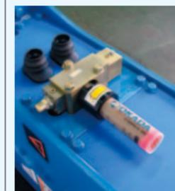
電気配線を必要とせず、TOP-100以上に取り付け事ができ、タガネやプッシングの長寿命化を図り、メンテナンスのための休止時間を削減します。
